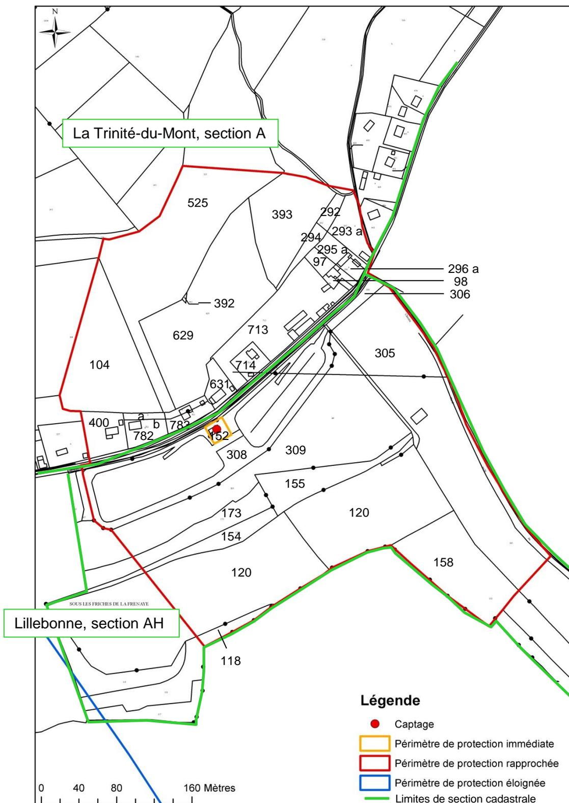
Figure 40 : Périmètres de protection immédiate et rapprochée du forage du Puits Maillé, sur fond cadastral
